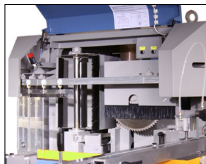
Plusieurs jeux d'outils peuvent être montés sur les arbres longs de 545.
